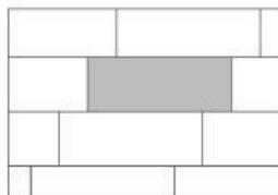
Productos de formato rectangular, con dimensiones de 60 cm hasta 120 cm de largo, con un patrón de instalación escalonado, se deben de colocar con un desfase mínimo de 15% hasta un máximo de 30%.
