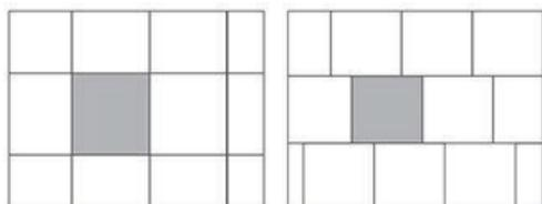
Productos de formato cuadrado, con un patrón de instalación escalonado, se deben de colocar con un desfase mínimo de 15% hasta un máximo de 30%.
