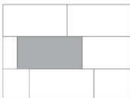
Productos de formato rectangular, con dimensiones de 30 cm hasta 45 cm de largo, con un patrón de instalación escalonado, se deben de colocar con un desfase mínimo de 15% hasta un máximo de 30%.
