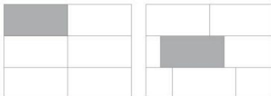
Productos de formato rectangular, con dimensiones de 60 cm hasta 120 cm de largo, con un patrón de instalación escalonado, se deben de colocar con un desfase mínimo de 15% hasta un máximo de 30%.
