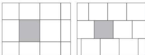
Productos de formato cuadrado, con un patrón de instalación escalonado, se deben de colocar con un desfase mínimo de 15% hasta un máximo de 30%.
