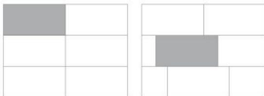
Productos de formato rectangular, con dimensiones de 60 cm hasta 120 cm de largo, con un patrón de instalación escalonado, se deben de colocar con un desfase mínimo de 15% hasta un máximo de 30%.
