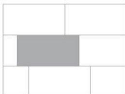
Productos de formato rectangular, con dimensiones de 60 cm hasta 120 cm de largo, con un patrón de instalación escalonado, se deben de colocar con un desfase mínimo de 15% hasta un máximo de 30%.
