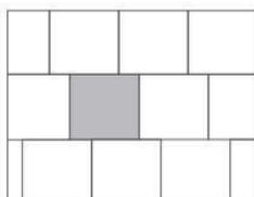
Productos de formato cuadrado, con un patrón de instalación escalonado, se deben de colocar con un desfase mínimo de 15% hasta un máximo de 30%.
